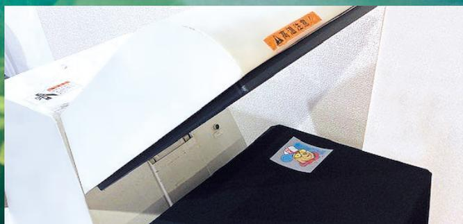
ヒートプレス機は主に対象物同士を熱圧着する際に使用します。マークやデザインの接着強度や耐久性を決める重要な機器です。弊社では熱板の温度均一性や圧力精度、使いやすさにこだわった自社製品を提供しています。豊富なオプションや部材を保有しており、導入後のメンテナンスも安心してお使いいただけます。
